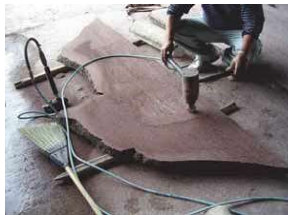
写真-5 舗装になる戸室石の選定、加工指導
