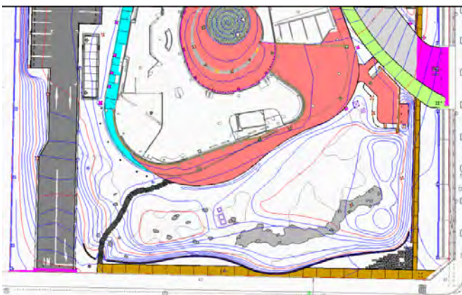
データを取込み等高線を図示化
