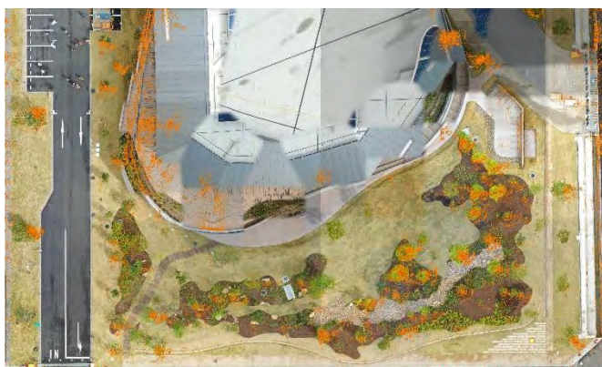
ドローン測量にて取得した高さデータ（橙色部高さ記載）
