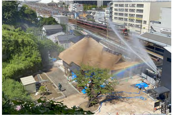
自動首振り放水銃 放水試験
